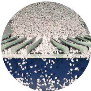
Alle Reste und Profilabschnitte aus der Fertigung sowie die Altfenster werden von TROCAL Fachbetrieben eingesammelt, gereinigt und wieder zu Granulat eingemahlen.
