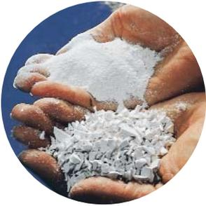
Dieses Regenerat bildet in einem speziell entwickelten Herstellungsverfahren die Basis für neue Profile.
