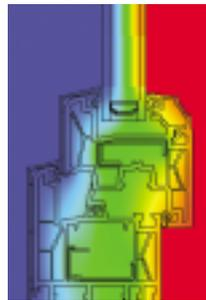
Der Materialmix Kunststoff plus Aluminium zeichnet sich durch hervorragende Wärmedämmwerte aus.
